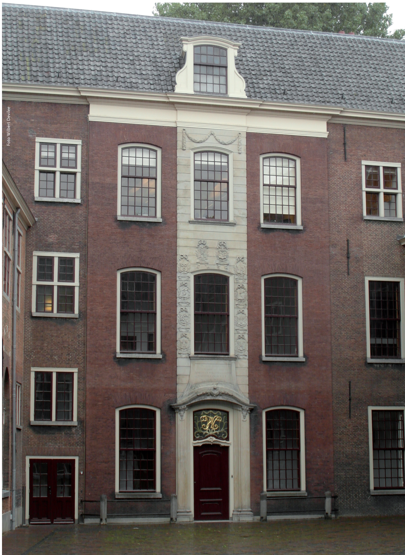
Een goed voorbeeld van een krachtig gevelbeeld, zoals dat vroeger door het gebruik van strakke bakstenen en dunne voegen werd nagestreefd.
